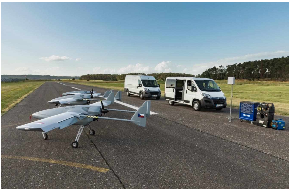
Obrázek B1 – Rozvinutý systém bezpilotního letounu včetně pozemní řídicí stanice (ve vozidle) a doprovodného (transportního) vozidla
